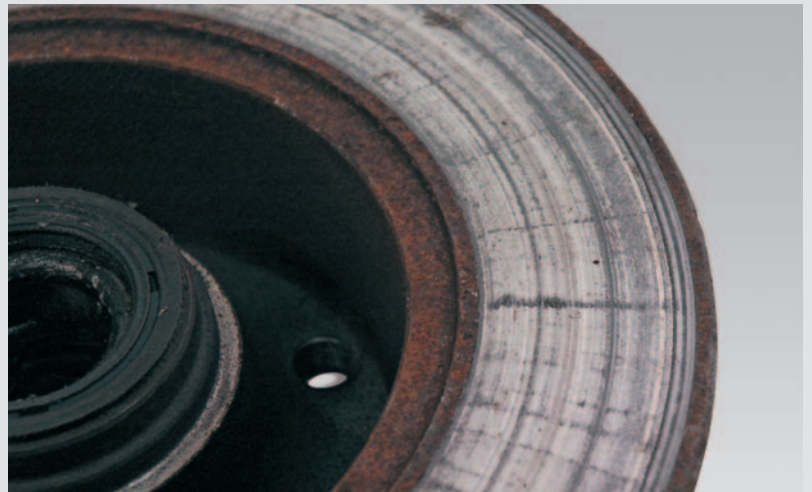
► Corroded brake disc
