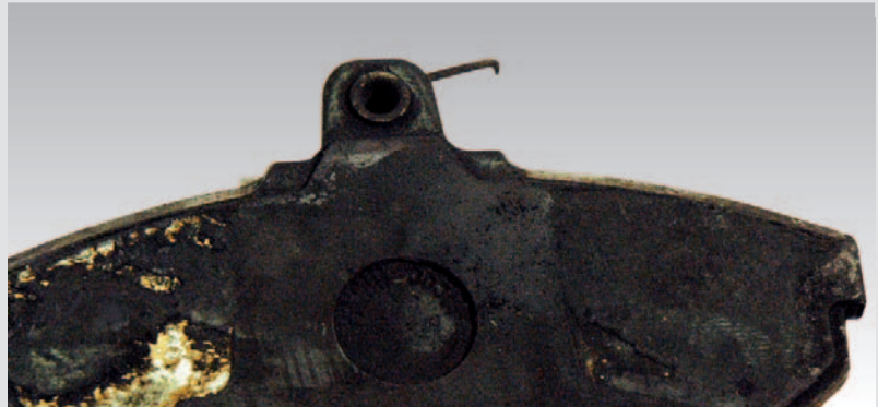
► Hold-down spring broken
