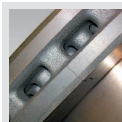
► Cracked brake disc
